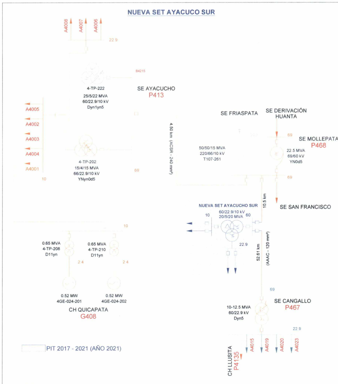
Figura 8. Diagrama Unifilar, implementación de la SET Huamanga Sur
