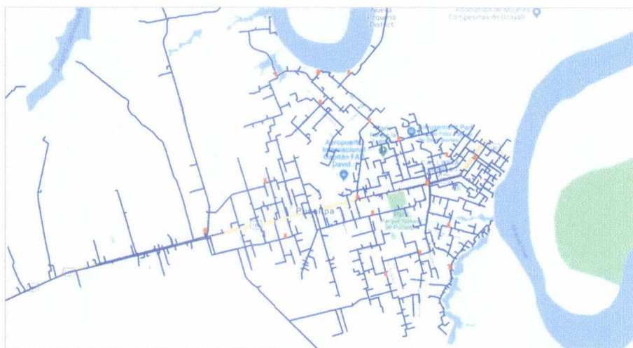
Figura 22: Ubicación de Reclosers en las redes MT de 10kV
