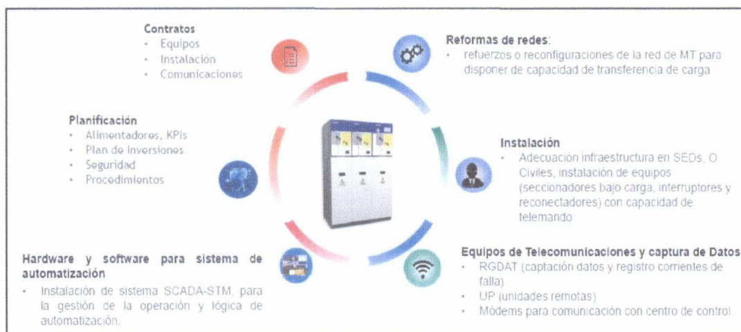
Figura 9: Proyecto Smart Grid ENEL
